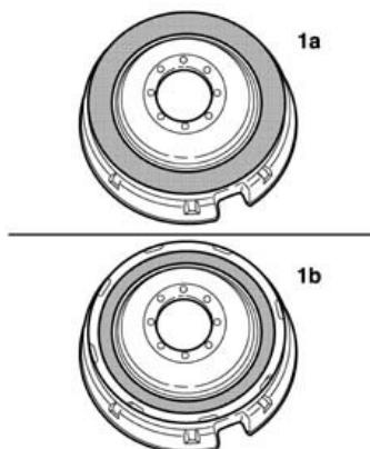
Ist das Lager richtig montiert oder ausgetauscht, das Gummilager wieder anbringen.
