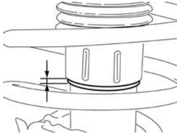
**Wenn der Staubschutz den Schließbund völlig abdeckt oder sogar darunter abschließt, ist möglicherweise der obere Puffer nicht richtig im oberen Lager des Stoßdämpfers eingesetzt.**
